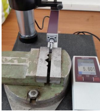
Fig. 2.6. Măsurarea rugozității epruvetelor
