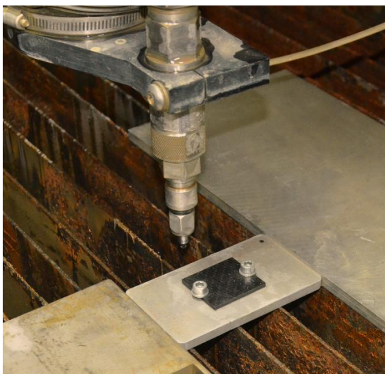
Fig. 1.13. Capul de tăiere Omax MAXJET 5
