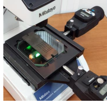
Fig. 2.7. Microscopul Mitutoyo TM 505, utilizat pentru măsurarea lățimii de tăiere
